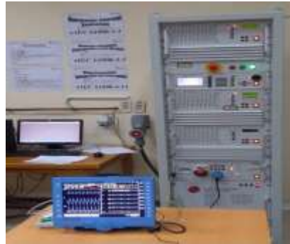
Fig. 35: Configuration de Creux de Tension et de Coupures Brèves
