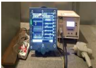
Fig. 30: Configuration d'Essai d'Immunité aux Décharges Électrostatiques (DES)
