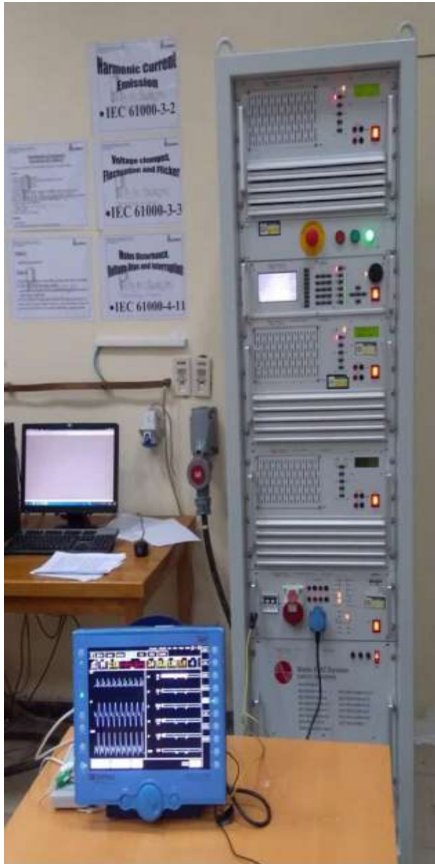
Fig 27: Configuration d'Essai des Émissions de Courant Harmonique
