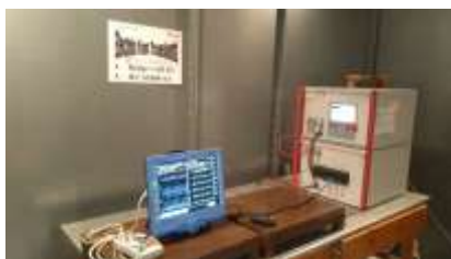
Fig. 31: Configuration d'Essai d'Immunité aux Transitoires Électriques Rapides
