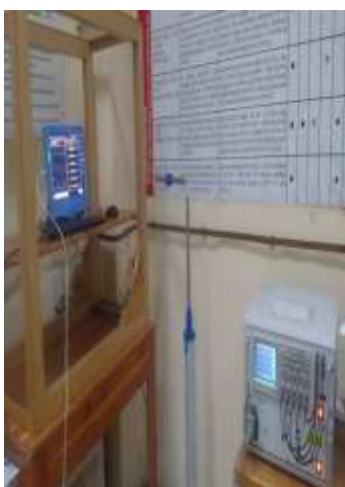
Fig. 34: Configuration d'Immunité au Champ Magnétique à la Fréquence du Réseau
